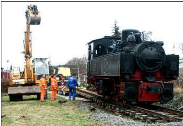
Mittels einer Seilwinde wird die 99 5902 auf den bereitstehenden Straßentiefelader gezogen (Bhf. Wernigerode-Hasserode, 11.01.2007)
